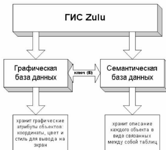
Рисунок 9.1. Структурная схема представления информации в системе Zulu
